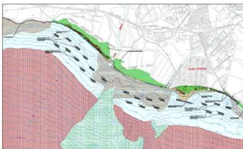
Planimetria del progetto con disposizione delle scogliere a bassa sommergenza.
